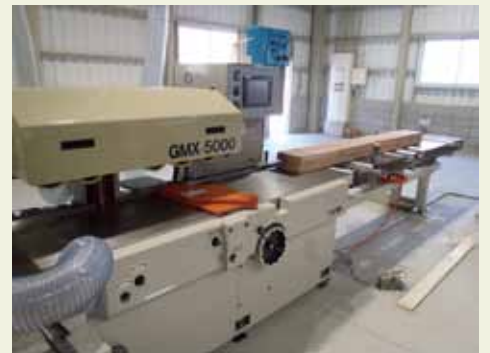
木材加工流通センターに設置された自動四面鉋盤
